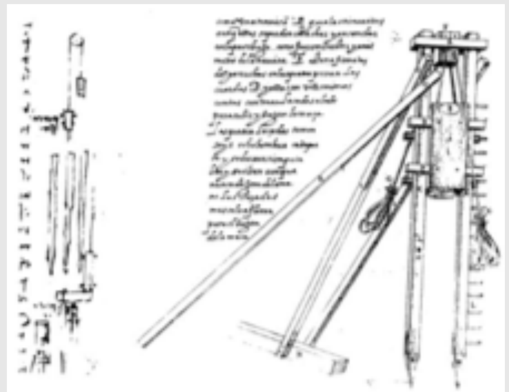
Figura 2. Máquinas para clavar pilotes en Leonardo (García, 1996)
