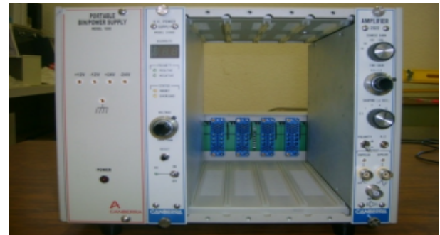
Fig. 2. Gabinete NIM portátil modelo 100.
