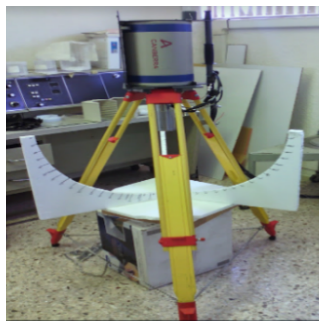
Fig. 6. Montaje experimental para la adquisición de radiación de fondo natural.
