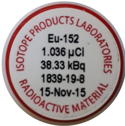
Figura 5. Fuente radiactiva de europio-152.
