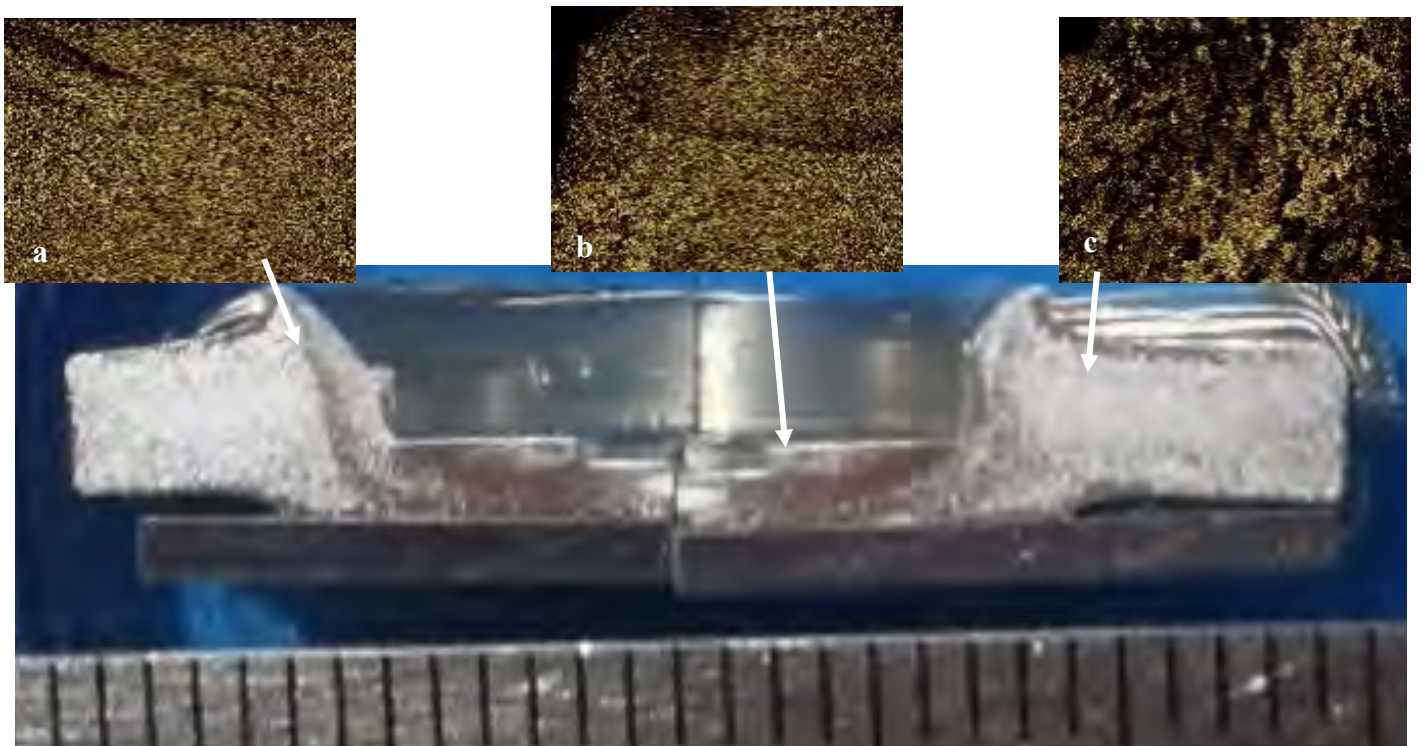
Fig. 10. Macrografía de la prueba a 60 % de penetración a) zona afectada termo-mecánicamente, b) zona de agitación y c) zona afectada por el calor.
