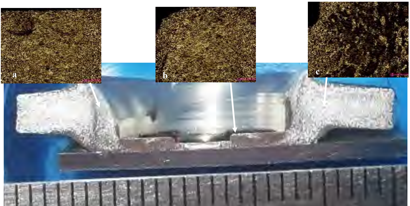
Fig. 12. Macrografía de la prueba a 90 % de penetración a) zona afectada termo-mecánicamente, b) zona de agitación y c) zona afectada por el calor.
