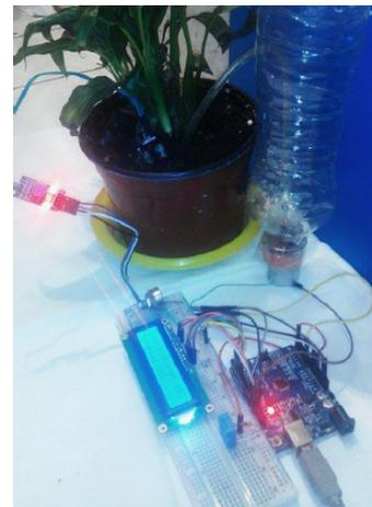
Fig. 9. Prueba del prototipo de la automatización del invernadero.
