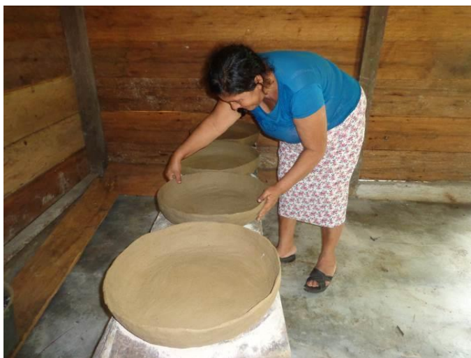
Figura 5. Proceso de secado del comal al interior de la vivienda (Foto: Elizabeth Puch Ku)
