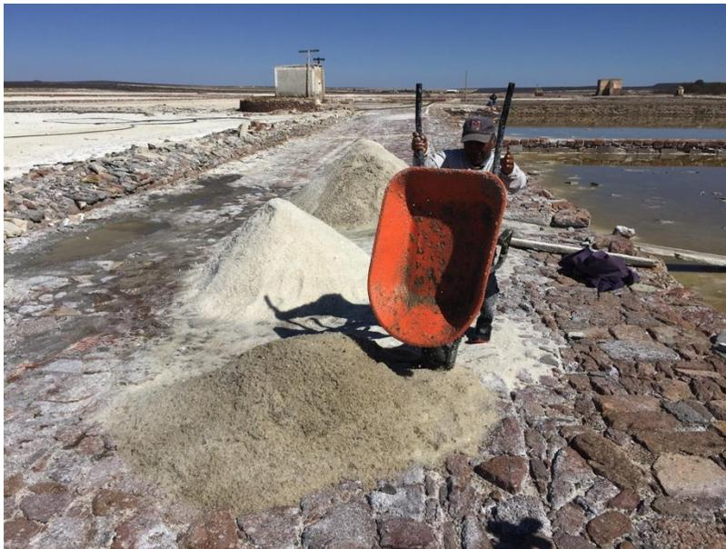
Figura 8: Carretilla con perforaciones utilizada para sacar la sal al asoleadero, Salinas de Hidalgo SLP, junio 2016 (fotografía del autor)
