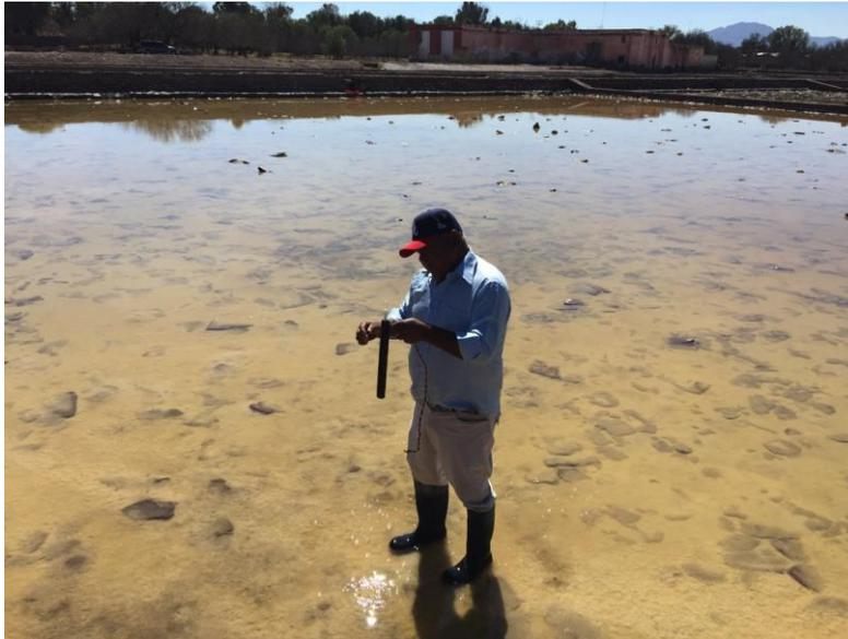
Figura 5: El salinero José Dimas midiendo la salinidad con un densímetro salinómetro Salinas de Hidalgo SLP, junio 2016 (fotografía del autor)
