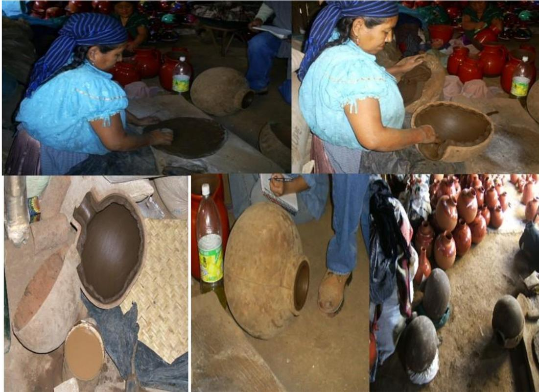
Figura 5: Parte izquierda superior elaboración de la tortilla de arcilla, derecha superior moldeado, parte izquierda inferior utensilios para la elaboración de las piezas, parte central los moldes de la pieza entera y derecha inferior desmolde y piezas en reposo.
