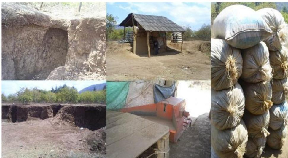
Figura 3: Izquierda arriba y abajo mina de arcilla, centro molino para material y orilla derecha costales empacados con arcilla molida.
