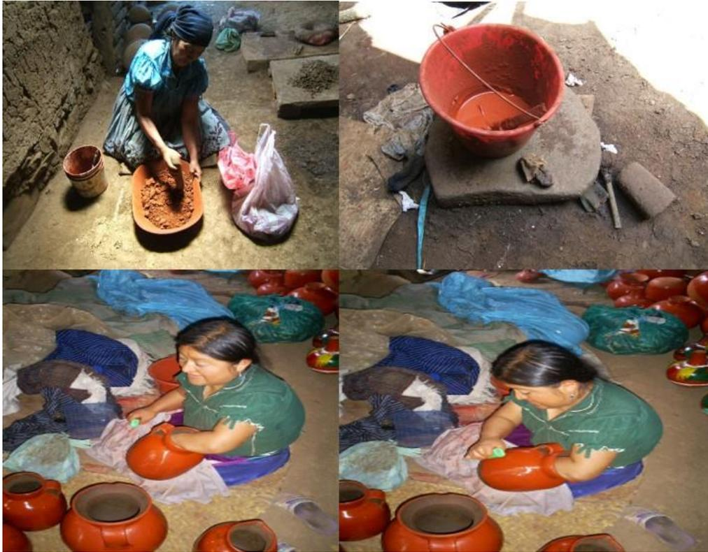
Figura 6: Parte izquierda superior, moliendo la charanda; derecha superior, charanda lista para aplicarse; parte de abajo, aplicación.
