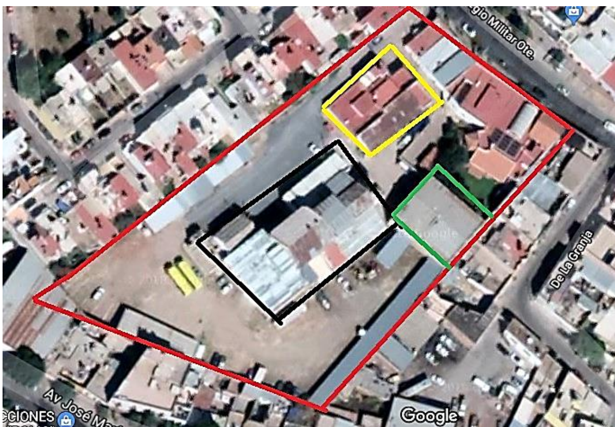
Figura 2. Imagen tomada de Google earth. (En negro, nave principal de la harinera; en verde, bodega adjunta y, en amarillo, construcción moderna).
