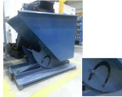
**Fig. 1.** Contenedor autovolcable con sistema de giro por ranura que se encuentra en Industrial B&S de México
