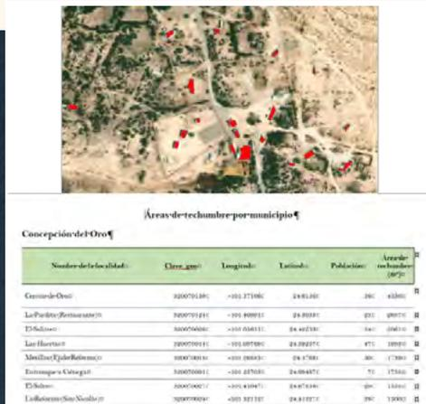
Figura 3. Ejemplo de detección de áreas de captación usando el algoritmo de inteligencia artificial en el municipio de Concepción del Oro, Zacatecas.
