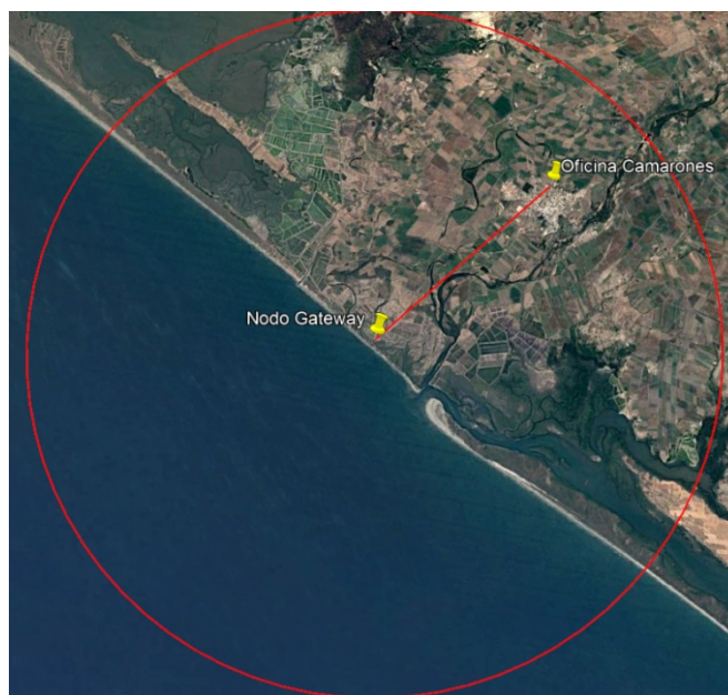
Figura 14. El círculo en rojo representa el hipotético alcance de lora de 15 km, la línea roja representa la distancia de 10 km que existe entre las oficinas de camarones y los estanques acuícolas en donde se encuentra el Gateway.
